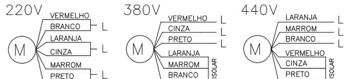
OBS: PARA INVERTER A ROTAÇÃO TROCAR UMA FASE DE ALIMENTAÇÃO
