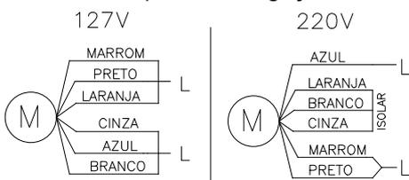
OBS: PARA INVERTER A ROTAÇÃO TROCAR O FIO BRANCO DO MOTOR PELO FIO PRETO
